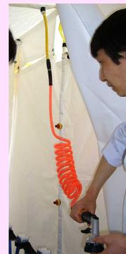
温水シャワー用ボイラーの OUTLET とテント横の黄色いホースをつなぎます。水源 INLET は圧力調整弁を通して水道の蛇口につなぎます。
